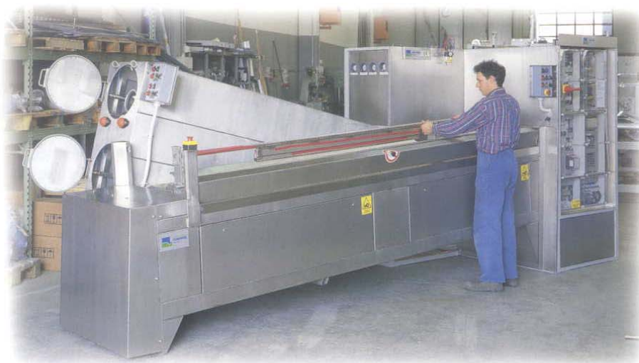
Estrazione del cilindro dalla racla fissata ad una estremità. Extraction of the screen from the squeegee fixed at one end.
