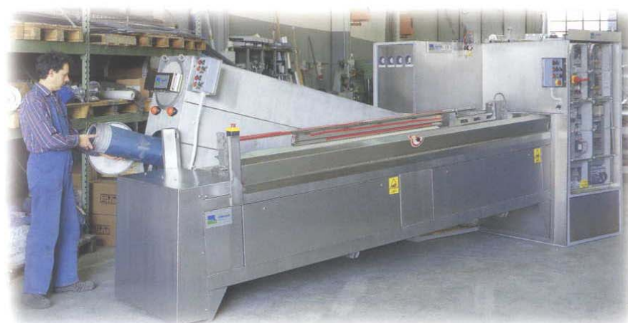
Posizionamento del cilindro nella stazione di lavaggio. Positioning of the screen in the washing station.
